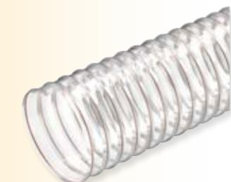
**Tubo trasparente in PU a base estere, rinforzato con spirale in acciaio ricoperto di poliuretano, color rame.** Spessore di parete da **0,4 mm a 0,75 mm**. Leggero e flessibile, resiste ad oli minerali, raggi UV, invecchiamento, agenti atmosferici, ozono e a molte sostanze abrasive. Conduttivo ( $R<10^2$  Ohm/m) mettendo a terra la spirale. Nell'industria della ceramica e nel settore della lavorazione del legno, per aspirazione di polveri e sostanze abrasive, trucioli e segatura.
