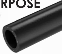
Tubo de PVC-P de color negro, con tubo interno de especial PVC-NBR y refuerzo textil de fibra de poliéster de alta tenacidad. Ligero y flexible; buena resistencia química, al envejecimiento y a la intemperie, aceites minerales y lubricantes. Tubo multiusos utilizado en industria y agricultura para suministro a presión de agua, aire comprimido, aceites, lubricantes y líquidos compatibles. Versiones de color bajo pedido (rojo, azul, azul claro con interior blanco).
