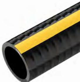
Tubo de color negro con raya amarilla, de compuesto especial de PVC-P, con refuerzo textil de poliéster y espiral de acero, que le confiere una excelente resistencia al aplastamiento. Liso y muy flexible incluso a bajas temperaturas, es resistente a numerosos productos químicos y a los agentes atmosféricos. Aspiración y transporte de agua y líquidos en la industria y la agricultura; riego. Conductivo ( $R<10^2$  Ohm/m) conectando a tierra la espiral.
