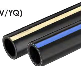
Tubos de PVC-P de color negro, respectivamente con banda de identificación beige (YV) y azul (YQ), con refuerzo textil de fibra de poliéster. Resistentes a la intemperie y a numerosos productos químicos. En agricultura, se utilizan para pulverización/riego, suministro a presión de soluciones fertilizantes y pesticidas, en pulverizadores.
