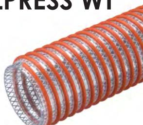
**Tubo transparente de PVC-P especial, con refuerzo textil de fibra de poliéster y espiral de PVC rígido antichoque de color naranja.** Interior liso y exterior corrugado. Calidad alimentaria, según UE 10/2011 (simulantes A, B, C, D1). Aspiración e impulsión de agua y líquidos, incluso a alta presión y en condiciones severas, en sistemas de bombeo y descarga de agua en suelos agrícolas.
