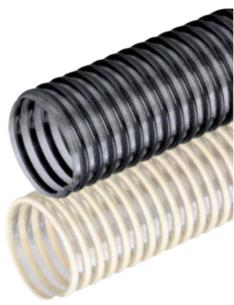
**Tubo transparente de especial TPU ANTIUV con espiral de PVC rígido antichoque de color marfil o negro (col. 26).** Fabricado con aditivo especial ANTIUV, para evitar el riesgo de amarilleamiento de la pared durante la exposición al sol. Interior liso y exterior corrugado. Espesor de pared de **0,4 mm a 0,7 mm**. Ligero y especialmente flexible, resistente a la abrasión, a los microbios y a la hidrólisis. Utilizado para la aspiración en sembradoras agrícolas.
