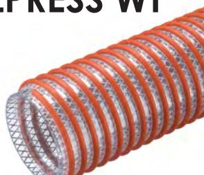
**Tubo trasparente in speciale PVC-P, con rinforzo tessile in fibra di poliestere e spirale in PVC rigido antiurto arancione.** Interno liscio ed esterno corrugato. Alimentare, secondo UE 10/2011 (classi A, B, C, D1). Aspirazione e mandata di acqua e liquidi, anche a pressioni elevate e in condizioni severe, su sistemi di pompaggio e water discharge del suolo agricolo.
