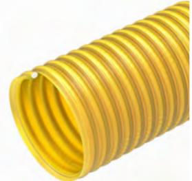
**Tubo giallo trasparente in PVC-P, con spirale di rinforzo in PVC rigido antiurto colore avorio.** Superficie interna completamente liscia, esterna semi liscia. Maneggevole, leggero e flessibile, resiste a carichi, ozono, agenti atmosferici e a molti prodotti chimici. Alimentare, secondo UE 10/2011 (classi A, B, C). Aspirazione e mandata di liquidi, concimi e soluzioni comunemente utilizzate in agricoltura, su carri botte e veicoli spandiconcime; aspirazione e mandata di liquidi alimentari.
