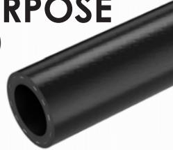
Tubo nero in PVC-P, con sottostrato in speciale formulazione PVC-NBR e rinforzo tessile in fibra di poliestere ad alta tenacità. Leggero e flessibile; buona resistenza chimica, ad invecchiamento e agenti atmosferici, oli minerali e lubrificanti. Molto versatile, esso viene impiegato in agricoltura, per mandata in pressione di acqua, aria e sostanze oleose. Versioni colore su richiesta (rosso, blu, azzurro con interno bianco).
