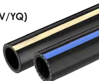
Tubi neri in PVC-P, rispettivamente con striscia identificativa beige (YV) e azzurra(YQ), con rinforzo tessile in fibra di poliestere. Resistenti agli agenti atmosferici e a gran parte dei prodotti chimici. In agricoltura, impiegati per irrorazione/spraying, mandata in pressione di soluzioni fertilizzanti e antiparassitarie, su atomizzatori.
