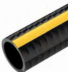
Tubo nero con riga gialla, in speciale compound in PVC-P, con rinforzo tessile di poliestere e spirale in acciaio, la quale consente un'ottima resistenza allo schiacciamento. Liscio e molto flessibile anche a basse temperature, resiste a numerose sostanze chimiche ed agenti atmosferici. Aspirazione e mandata di acqua e liquidi nell'industria e in agricoltura; irrigazione. Conduttivo ( $R<10^2$  Ohm/m) mettendo a terra la spirale.
