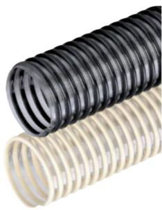
**Tubo trasparente in speciale TPU antiuv, con spirale in PVC rigido antiurto color avorio o nera.** Realizzato con speciale additivo ANTIUV, al fine di evitare il rischio di ingiallimento della parete, durante l'esposizione solare. Interno liscio ed esterno corrugato. Spessore di parete da **0,4 mm** a **0,7 mm**. Leggero e particolarmente flessibile, resiste all'abrasione, a microbi ed idrolisi. Impiegato per aspirazione su macchine agricole per la semina.
