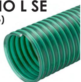
**Tubo verde trasparente in speciale PVC-P superelastico, con spirale di rinforzo in PVC rigido antiurto color avorio.** Interno completamente liscio, esterno semi-liscio. Grazie alla speciale formulazione, mantiene un'elevata flessibilità anche a basse temperature. In agricoltura, eccellente per aspirazione e mandata di fertilizzanti e liquidi in genere; particolarmente adatto su macchine spandiliquame.
