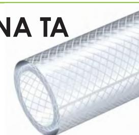
Tubo trasparente in PVC-P, con rinforzo tessile in fibra di poliestere ad alta tenacità. Leggero e molto flessibile, resiste agli agenti atmosferici e a gran parte dei prodotti chimici. Alimentare, secondo UE 10/2011 (classi A, B, C). In agricoltura e giardinaggio, utilizzato per irrigazione e trasporto liquidi.
